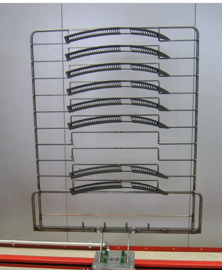
Telaio per verniciatura, destinato ai convogliatori a terra. La griglia in materiale plastico è tenuta insieme da un'asta in filo metallico e da due molle di serraggio.
