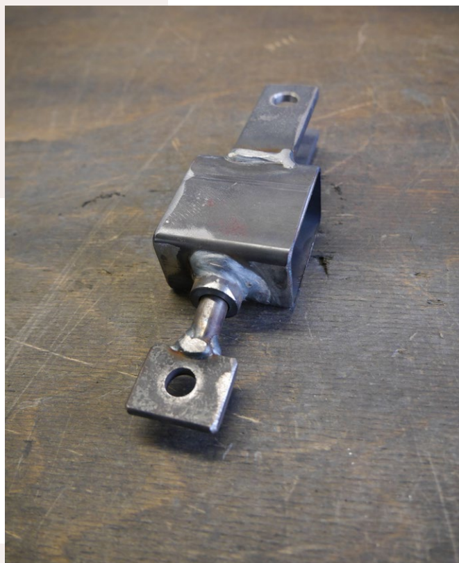
Dispositivo rotante aperto, con meccanismo di sicurezza 90°.
