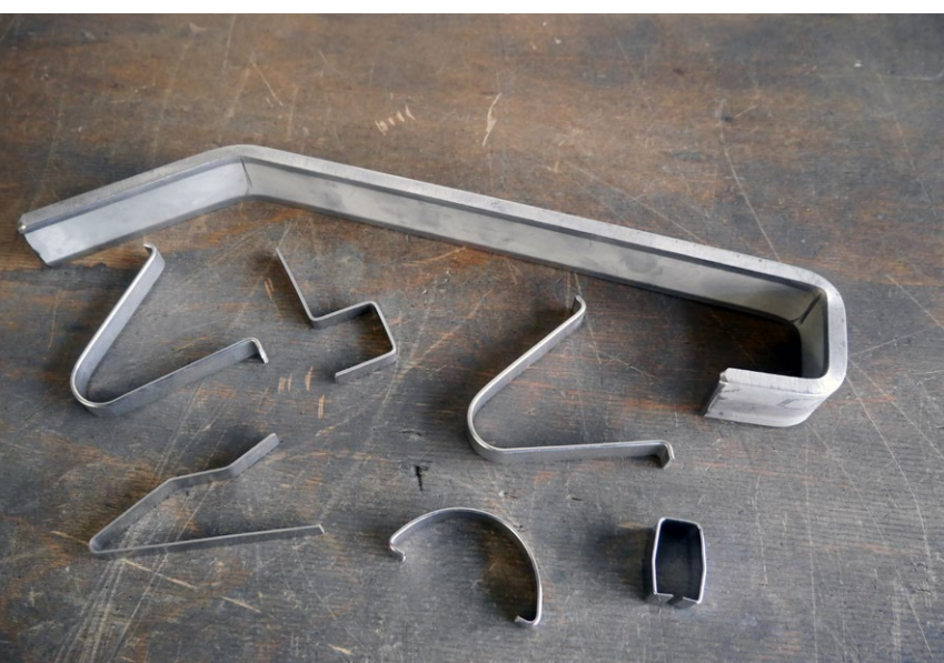
Morsetti a molla in acciaio armonico VA e ganci per appendere realizzati in materiale piatto (30 x 7 mm).
