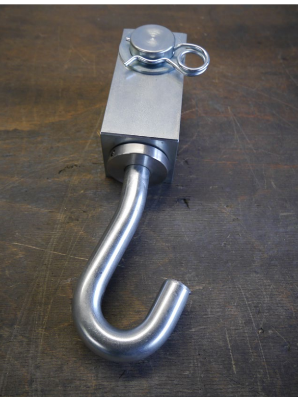
Dispositivo rotante adeguato all' impianto per verniciatura (carico max 750 kg).
