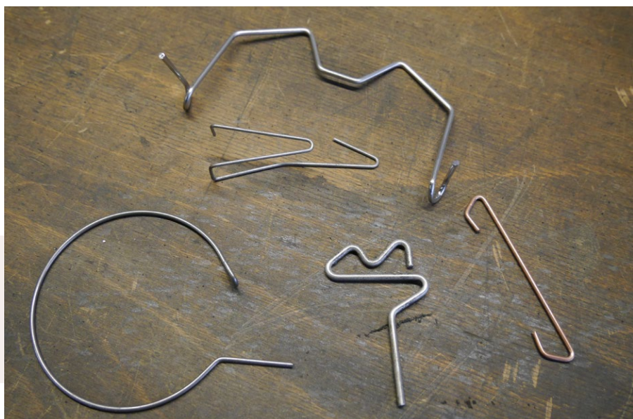
Componenti a due e tre dimensioni, realizzati in filo metallico piegato, con diametri compresi tra 1,5 e 3 mm.
