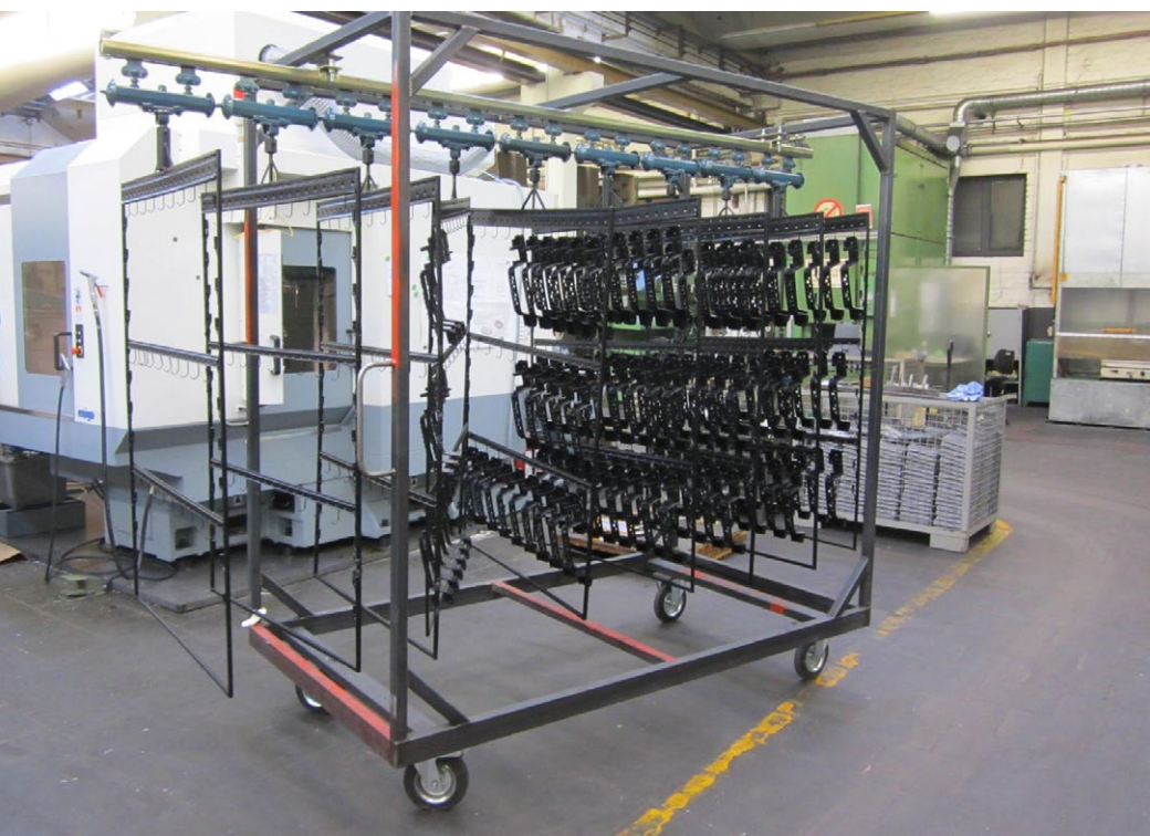
Carrello per il trasporto di telai compreso il carrello per il trasferimento rapido all'impianto di verniciatura.
