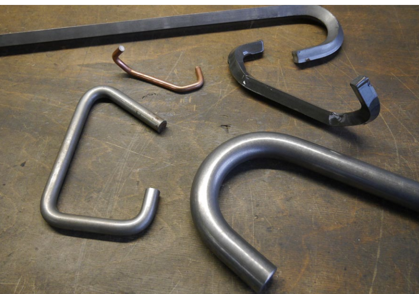
Pezzi piegati a sezione circolare o quadrangolare, con diametro compreso tra 8 e 30 mm.
