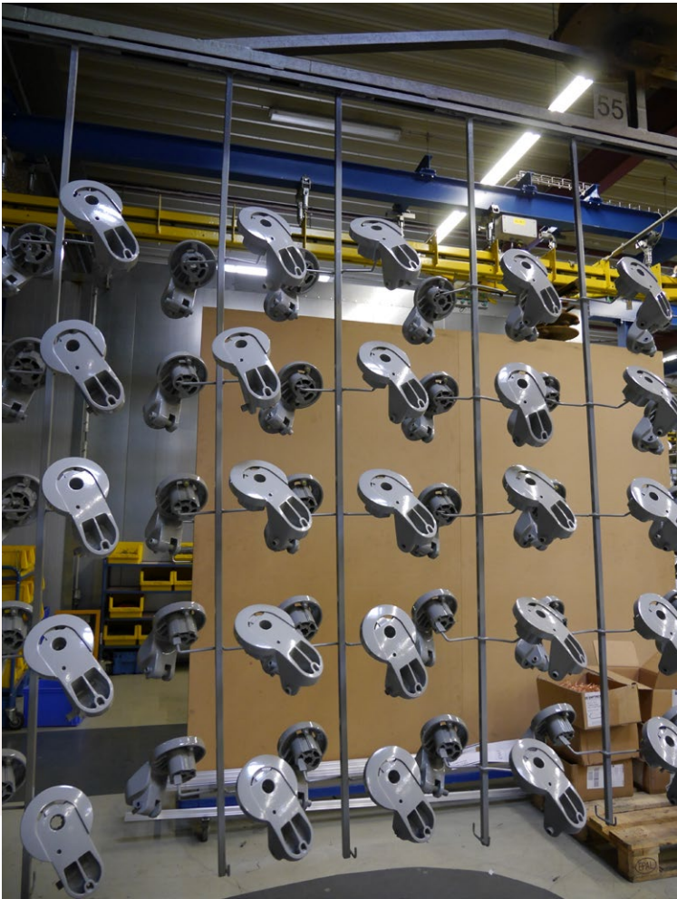
Dispositivo di fissaggio verticale con bracci di fissaggio stabilmente vincolati mediante saldatura. I componenti sono collocati a distanze stabilite.
